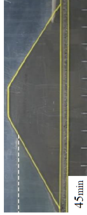
図8 堤防底部に砂層層を有する場合の浸透破壊実験：(a)上図、砂層部：豊浦砂；(b)下図、砂層部：上層珪砂7号・下層珪砂2号。右の写真は堤内側法尻部における実験から45分後の様子。
