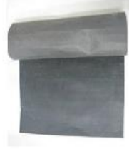
図-2 左: 透気遮水シート, 右: シートと土槽の結合方法
